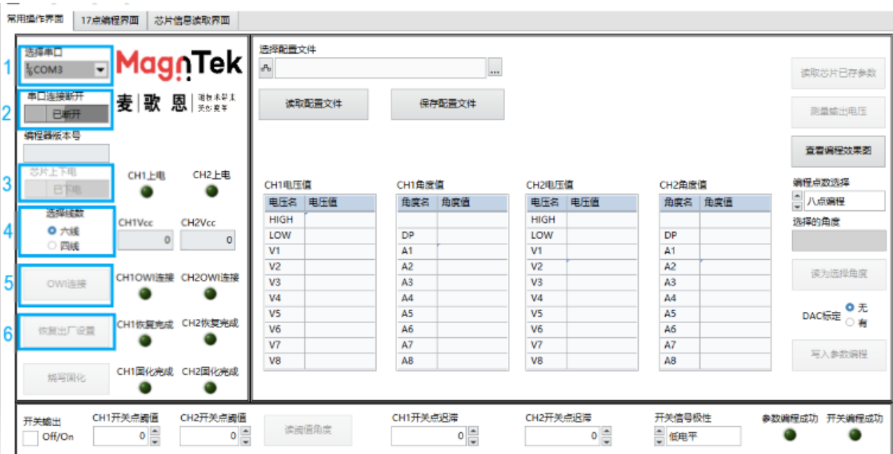
图5.1.2 双芯片模拟输出编程主界面
