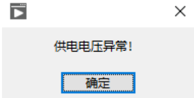
图 5.2.7 芯片上电异常后弹出报警框
