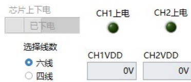
图 4.2.2 芯片上下电按钮及指示灯
