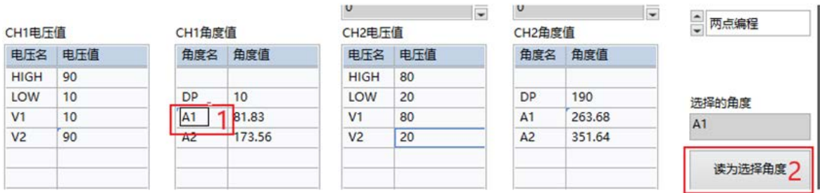
图5.5.11 读取 A1/A2 编程角度值
