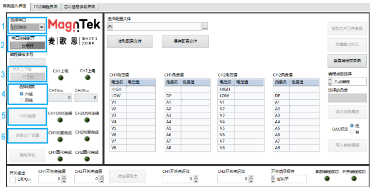
图 5.3.2 双芯片模拟输出编程主界面
