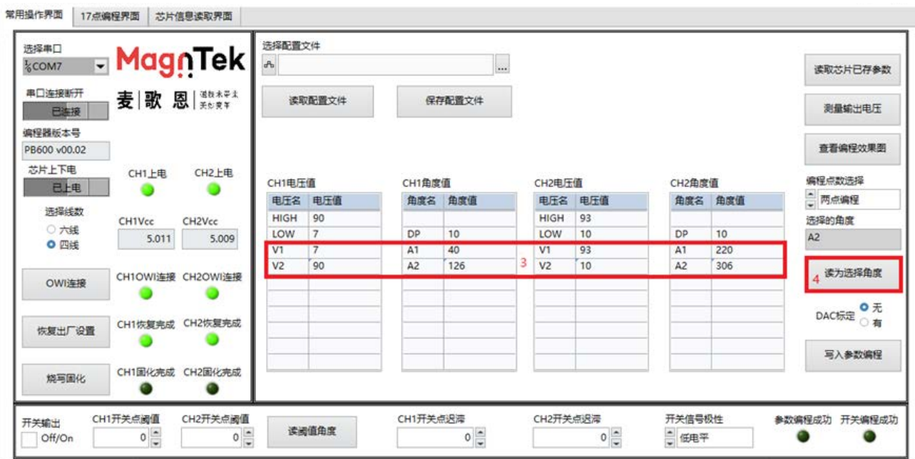
图 5.2.11 读取 A1/A2 编程角度值
